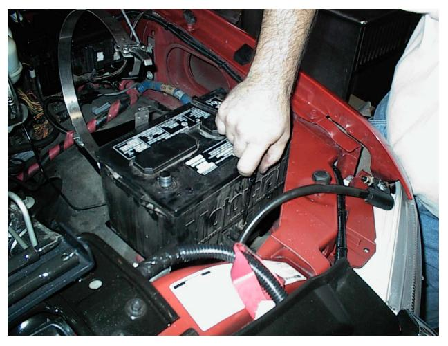
10) INSTALL THE BATTERY USING THE STOCK HOLD DOWN BOLT REMOVED EARLIER. THE BATTERY CABLES CAN NOW BE RECONNECTED, GROUNDS FIRST THEN POSITIVES. IF THE VEHICLE HAS ANY ACCESSORY CABLES TO THE POSITIVE SIDE THEY SHOULDBE RE-ROUTED NOW TO RUN UNDER THE SNORKEL OF THE NEW FILTER CANISTER. THIS WILL MAKE FILTER MAINTENANCE MUCH EASIER WHEN IT IS TIME FOR SERVICE. MAKE SURE THE COVER IS INSTALLED ON THE POSITIVE CABLE. THE SNORKEL ON THE UMP SUPERFILTER COMES VERY CLOSE TO THIS WHEN SLIDING IT IN.
